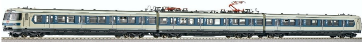
Eine 67,4 Meter lange Münchner S-Bahn-Garnitur mit den Triebwagen der Baureihen 420, 421 und 420.
